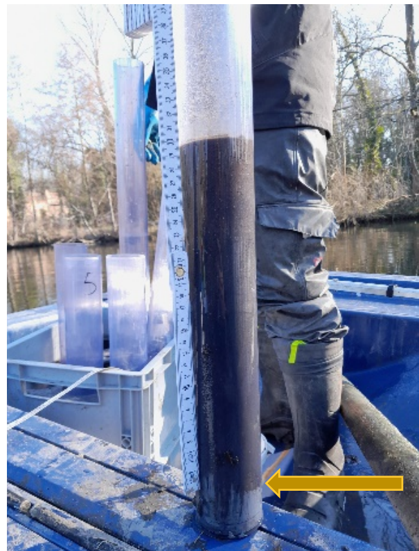
Abb. 2: Ermittlung der Sedimentauflage im Sedimentstechrohr (Methode C). Der Pfeil markiert die Oberkante der Teichabdichtung aus Ton.
