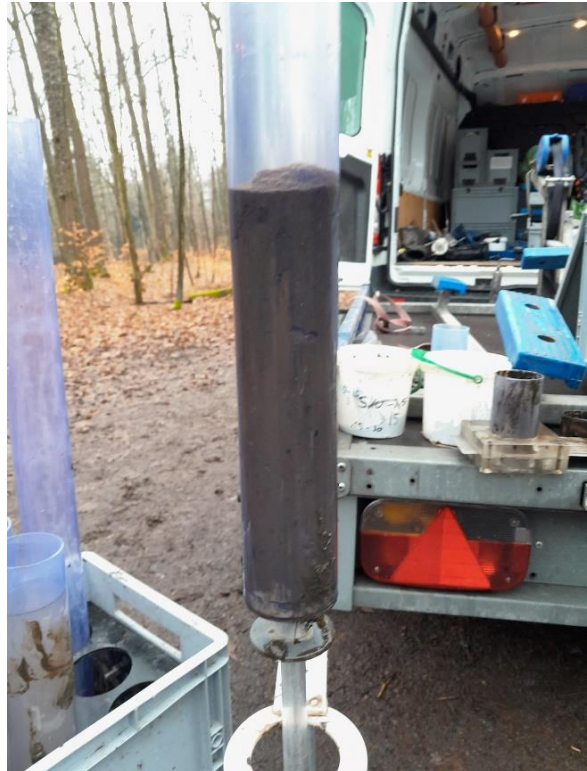
Abbildung 21: Messung des Pegelstands am Blaubornteich von der Oberkante des Ablassbauwerks (Mönch) nach unten gerichtet (links). Sedimentkern aus dem Blaubornteich im Februar 2024, homogen braun gefärbt (rechts).
