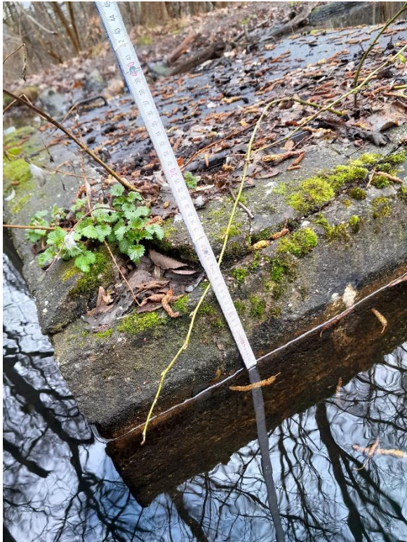
Abbildung 21: Messung des Pegelstands am Blaubornteich von der Oberkante des Ablassbauwerks (Mönch) nach unten gerichtet (links). Sedimentkern aus dem Blaubornteich im Februar 2024, homogen braun gefärbt (rechts).
